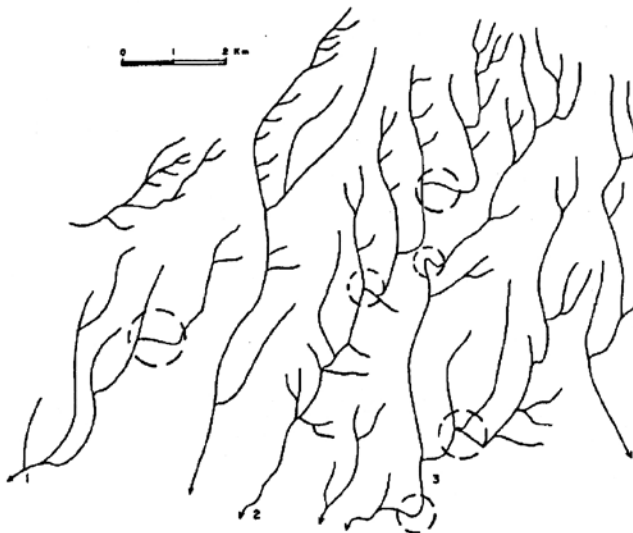
Figura 8. Avenamiento de la zona de piedemonte correspondiente al nivel base de Taxhimay, estado de México. Esquema de la disposición del patrón de drenaje. Se muestra el cambio abrupto de rumbo, y para las corrientes numeradas 1, 2 y 3, se observa la intersección entre canales casi perpendicular o en ángulo recto o mayor.
