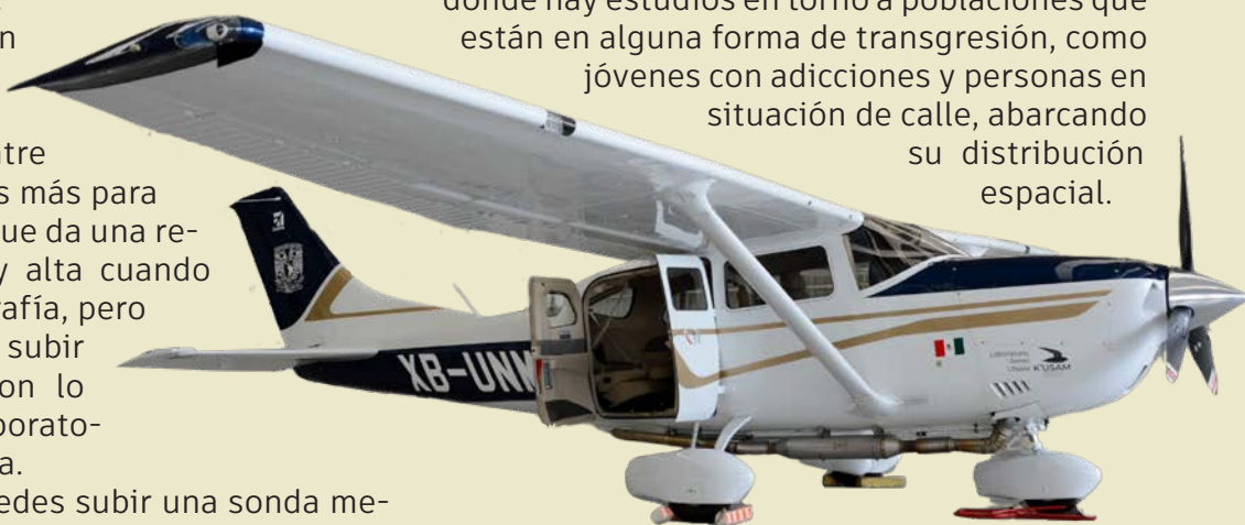
K'usam es una aeronave pequeña con motor de pistón turbocargado, lo que le permite volar hasta a 26,000 pies (7,925 metros) sobre el nivel medio del mar. Se pueden instalar cámaras aerofotográficas y barreadores lidar en el piso del avión.
