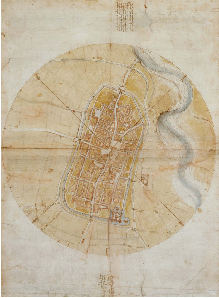
Figura 4.4. Plano de la ciudad de Imola con objetivos militares dibujado por Leonardo da Vinci a petición de César Borgia, 1502. La proyección perpendicular es una innovación genial de su autor quien se sirvió probablemente de un astrolabio para obtener las medidas proporcionales. Otra innovación son las curvas paralelas que dan la sensación de profundidad en el curso del río Santerno. Repositorio: Museo Leonardiano, Vinci.
