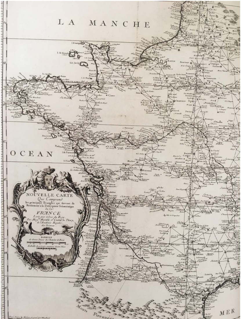
Figura 4.8. Triangulaciones para la construcción del mapa de Francia por los Cassini, según órdenes de Luis XIV. Esta familia de cartógrafos encuentra la manera de representar los espacios continentales guardando proporciones mediante triángulos referenciados cosmográficamente. Detalle de la Carte de France par Cassini de Thury , grabado sobre cuero, 1744. Repositorio Bibliothèque Nationale de France.
