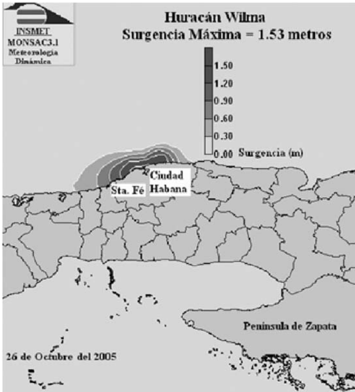
Figura 7. Cálculo de la altura de la surgencia que acompañó al huracán Wilma, según modelo cubano MONSAC 3.1 del Instituto de Meteorología de Cuba, 2005.
