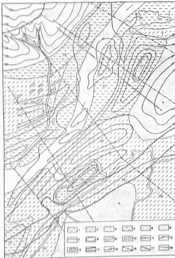
Fig. 22. Fragmento de un mapa geomorfológico de un valle fluvial, aplicado a la construcción de una hidroenergética (N. Riabkov y N. Siagaev, 1975). 1. Llanura de inundación; 2. I terraza; 3. III terraza; 4. IV terraza; 5. V terraza; 6. Ladera del valle; 7. Escarpes de erosión; 8. Hoyas de deflación; 9. Depresiones de lago abandonado; 10. Montículos y dunas eólicas; 11. Barrancos activos; 12. Isolíneas del techo del sustrato rocoso; 13. Porciones de levantamientos modernos reconocidos por datos geológico-geomorfológicos; 14. Cauces sepultados; 15. Isolíneas de la superficie de laderas; 16. Líneas de diques y pozos; 17. Línea de variante óptima para la construcción de la cortina; 18. Cauce del río y dirección de éste.
